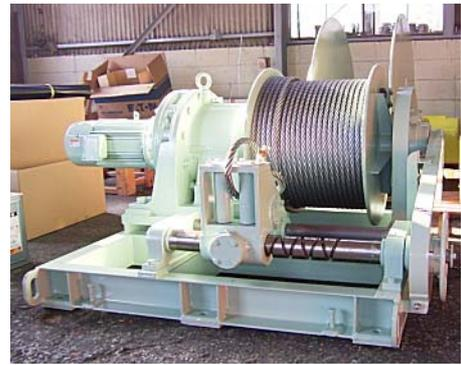
Fig.17 巻胴 (巻き上げドラム hoisting drum)
